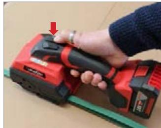
Tensionamento tramite pulsante
