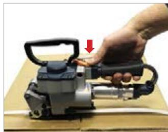
Tensionamento tramite pulsante
