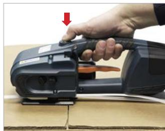
Tensionamento tramite pulsante
