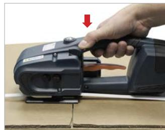
Saldatura tramite leva
