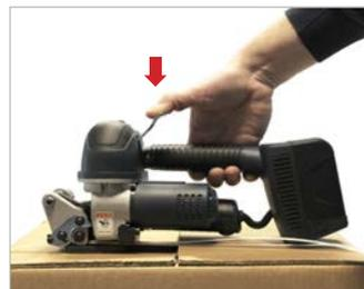
Saldatura tramite leva
